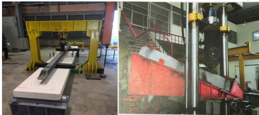
ภาพที่ 3 ทดสอบแผ่นพื้นคอนกรีตมวลเบา Flexural of Dimension concrete และทดสอบหมอนรางรถไฟคอนกรีต ที่มา : กฤษฎา ภูมิ, 2565
